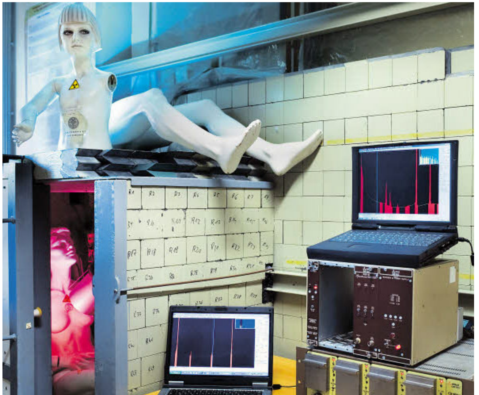
Mithilfe von sogenannten „radioaktiven Puppen“ werden an der Universität Salzburg Strahlungsdetektoren geeicht.
